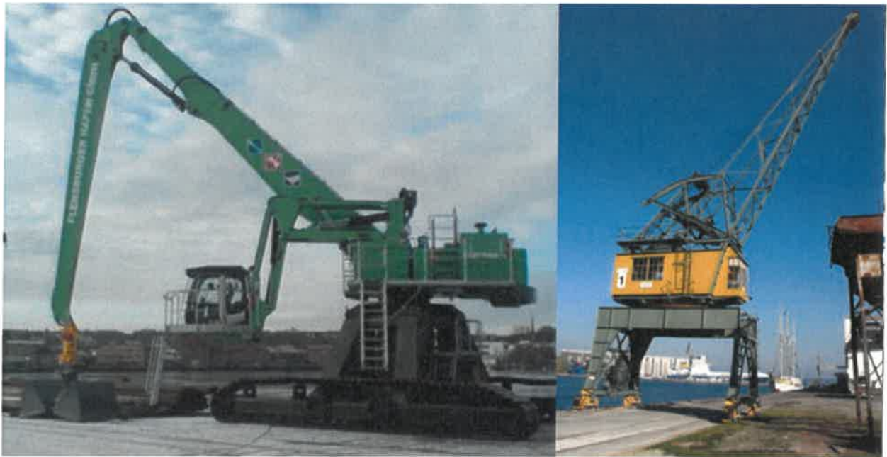
Abbildung 8: Umschlagmaschinen Hafen-Ostseite: links: Mantsinen RHC 60, rechts: Kran 1
